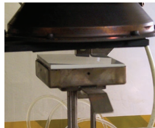
着火は10,000Vの電気スパークにて点火。
