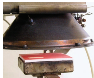
試料サイズ: 100mm×100mm×5mm(厚) 輻射熱50kw/m 2 で測定
