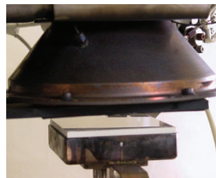
着火は10,000Vの電気スパークにて点火。
