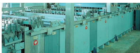
プリント基板製造装置 (耐熱プレート)
